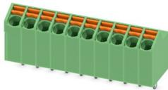
Leiterplattenklemme, Nennstrom: 9 A, Bemessungsspannung (III/2): 200 V, Nennquerschnitt: 1 mm<sup>2</sup>, Anzahl der Reihen: 1, Polzahl pro Reihe: 5, Artikelfamilie: SPTA 1/, Rastermaß: 3,5 mm, Anschlussart: Push-in-Federanschluss, Montage: Wellenlöten, Anschlussrichtung Leiter/Platine: 65 °, Farbe: grün, Pin-Layout: Lineares Pinning, Pinlänge [P]: 3,5 mm, Anzahl der Lötpins pro Potenzial: 1, Verpackungsart: verpackt im Karton
