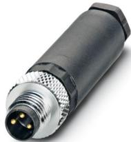
Steckverbinder, Universal, 3-polig, Stecker gerade M8, Kodierung: A, Schraubanschluss, Rändelmaterial: Messing, vernickelt, Leitungsaußendurchmesser 3,5 mm ... 5 mm
