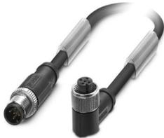
Sensor-/Aktor-Kabel, 5-polig, PUR halogenfrei, schwarzgrau RAL 7021, geschirmt (Advanced Shielding Technology), Stecker gerade M12, Kodierung: A, auf Buchse gewinkelt M12, Kodierung: A, Kabellänge: 0,3 m
