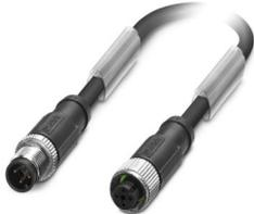
Sensor-/Aktor-Kabel, 4-polig, PUR halogenfrei, schwarzgrau RAL 7021, geschirmt (Advanced Shielding Technology), Stecker gerade M12, Kodierung: A, auf Buchse gerade M12, Kodierung: A, Kabellänge: 1,5 m
