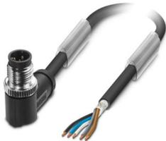
Sensor-/Aktor-Kabel, 5-polig, PUR halogenfrei, schwarzgrau RAL 7021, geschirmt (Advanced Shielding Technology), Stecker gewinkelt M12, Kodierung: A, auf freies Leitungsende, Kabellänge: 10 m
