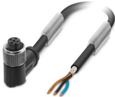
Sensor-/Aktor-Kabel, 3-polig, PUR halogenfrei, schwarzgrau RAL 7021, geschirmt (Advanced Shielding Technology), freies Leitungsende, auf Buchse gewinkelt M12, Kodierung: A, Kabellänge: 10 m
