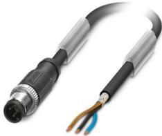
Sensor-/Aktor-Kabel, 3-polig, PUR halogenfrei, schwarzgrau RAL 7021, geschirmt (Advanced Shielding Technology), Stecker gerade M12, Kodierung: A, auf freies Leitungsende, Kabellänge: 10 m
