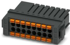
Leiterplattenstecker, Nennquerschnitt: 1,5 mm<sup>2</sup>, Farbe: schwarz, Nennstrom: 8 A, Bemessungsspannung (III/2): 160 V, Kontaktoberfläche: Sn, Kontaktart: Buchse, Anzahl der Reihen: 2, Polzahl: 16, Artikelfamilie: DD31PS 1,5/..., Rastermaß: 3,81 mm, Anschlussart: Push-in-Federanschluss, Anschlussrichtung Leiter/Platine: 0 °, Rasthaken: - ohne Rasthaken, Stecksystem: CONNEXIS DD, Verriegelung: Rastverriegelung, Befestigungsart: Rastflansch, Verpackungsart: verpackt im Karton
