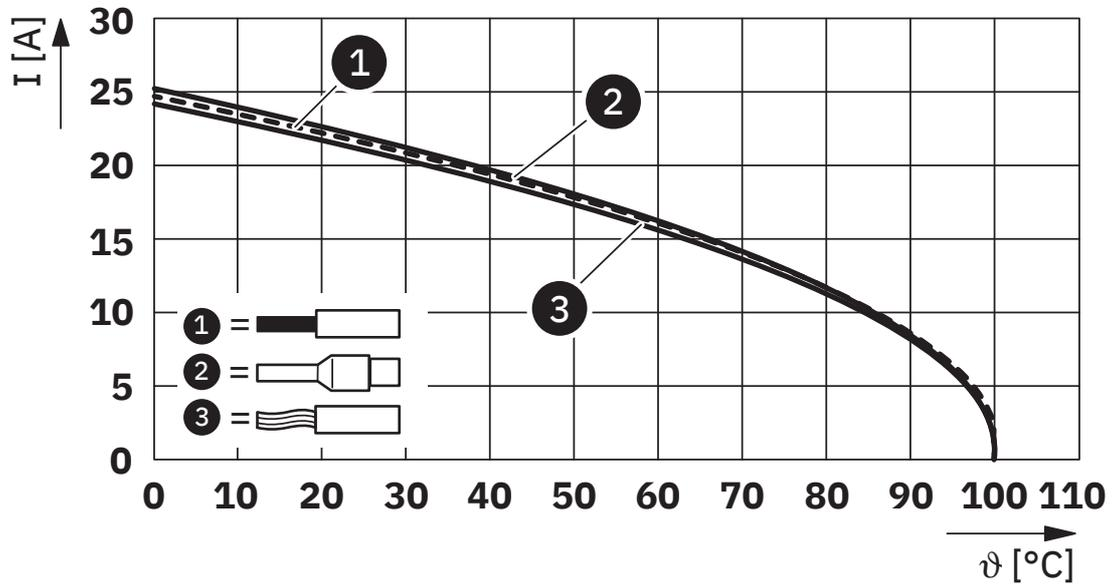
Derating-Diagramm für 2,5 mm<sup>2</sup>
