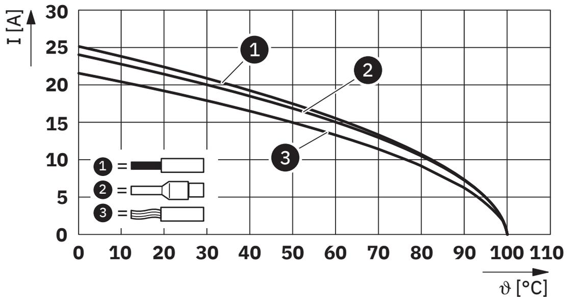
Derating-Diagramm für 1,5 mm<sup>2</sup>
