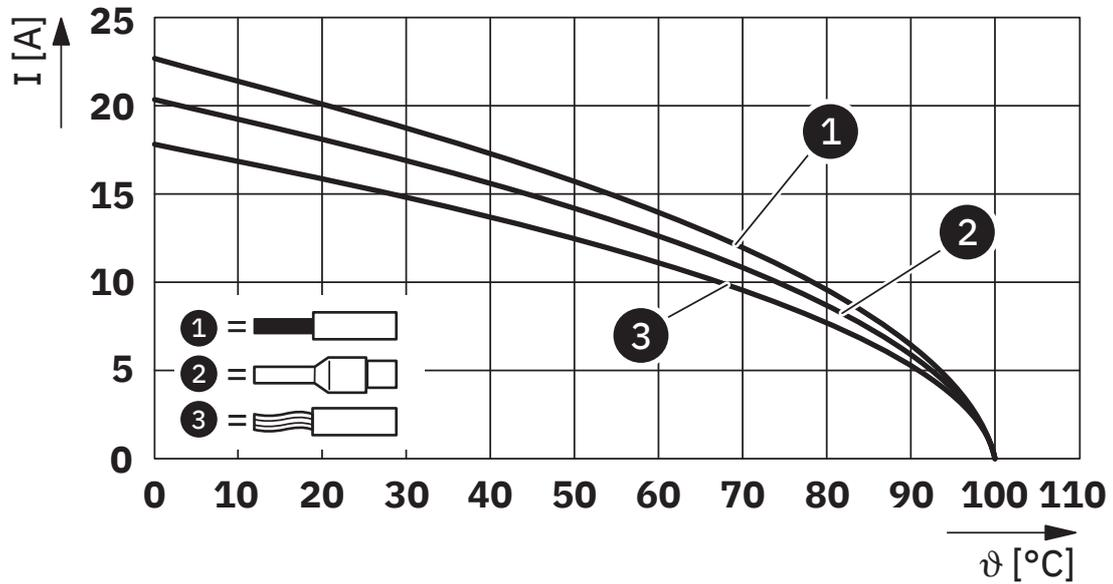
Derating-Diagramm für 1,0 mm<sup>2</sup>
