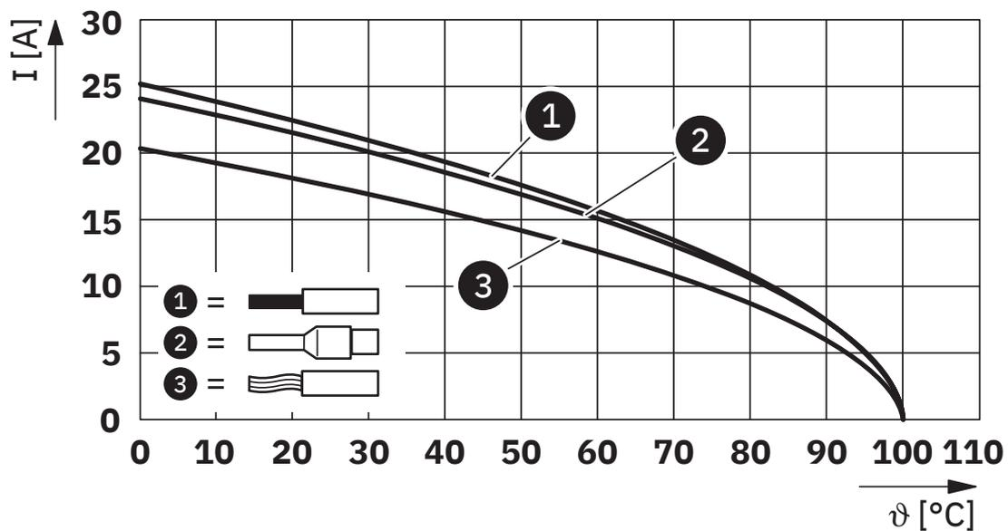
Derating-Diagramm für 1,0 mm<sup>2</sup>
