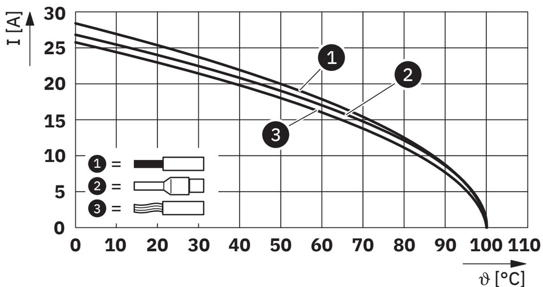
Derating-Diagramm für 1,5 mm<sup>2</sup>
