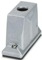
HEAVYCON ADVANCE-Tüllegehäuse, B24, mit Schraubverriegelung (Innensechskant) aus Edelstahl, seewasserbeständiges Aluminium, Höhe 93,7 mm, mit Gewinde, 1x M40 gerader Kabelabgang, 1x M25 gerader Kabelabgang, ohne Oberfläche; leitfähige Dichtung (EMV-Eigenschaften)
