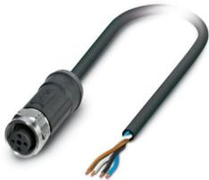
Sensor-/Aktor-Kabel, 4-polig, PE-X halogenfrei, schwarzgrau RAL 7021, freies Leitungsende, auf Buchse gewinkelt M12, Kodierung: A, Kabellänge: 65 m, für Außenanwendungen, mit Edelstahlrändel
