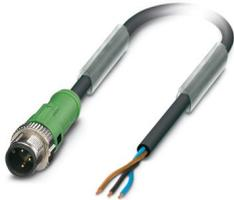
Sensor-/Aktor-Kabel, 3-polig, PUR/PVC, gelb, Stecker gerade M12 SPEEDCON, Kodierung: A, auf freies Leitungsende, Kabellänge: 1 m
