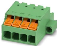
Leiterplattenstecker, Nennquerschnitt: 2,5 mm<sup>2</sup>, Farbe: grün, Nennstrom: 16 A, Bemessungsspannung (III/2): 320 V, Kontaktoberfläche: Sn, Kontaktart: Buchse, Anzahl der Reihen: 1, Polzahl: 4, Artikelfamilie: XPC 2,5/..-STF, Rastermaß: 5,08 mm, Anschlussart: Push-X-Anschluss, Anschlussrichtung Leiter/Platine: 0 °, Rasthaken: - ohne Rasthaken, Stecksystem: COMBICON MSTB 2,5, Verriegelung: Schraubverriegelung, Befestigungsart: Schraubflansch, Verpackungsart: verpackt im Karton
