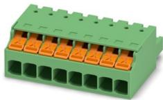
Leiterplattenstecker, Nennquerschnitt: 2,5 mm<sup>2</sup>, Farbe: grün, Nennstrom: 16 A, Bemessungsspannung (III/2): 320 V, Kontaktoberfläche: Sn, Kontaktart: Buchse, Anzahl der Reihen: 1, Polzahl: 8, Artikelfamilie: XPC 2,5/..-ST, Rastermaß: 5,08 mm, Anschlussart: Push-X-Anschluss, Anschlussrichtung Leiter/Platine: 0 °, Rasthaken: - ohne Rasthaken, Stecksystem: COMBICON MSTB 2,5, Verriegelung: ohne, Befestigungsart: ohne, Verpackungsart: verpackt im Karton
