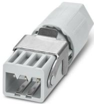
Steckverbinder, Anschlussart: IDC-Anschluss, Polzahl: 3+PE, 0,5 mm<sup>2</sup> ... 1,5 mm<sup>2</sup>, 400 V, 16 A AC/DC, grau, mit einer QUICKKON-Mutter, Leitungsaußendurchmesser: 7 mm ... 13 mm, Steckverbinder für den Motoranschluss von Raffstoren, Jalousien, Rollläden und Markisen
