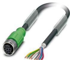
Sensor-/Aktor-Kabel, 8-polig, PUR halogenfrei, schwarzgrau RAL 7021, geschirmt, freies Leitungsende, auf Buchse gerade M12, Kodierung: A, Kabellänge: 50 m, Edelstahlrändel
