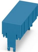
Tragschienegehäuse, 4U, Gehäuseabdeckung, Breite: 18,9 mm, Höhe: 43,8 mm, Tiefe: 26 mm, Farbe: blau (ähnlich RAL 5015)
