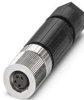
Steckverbinder, Universal, 4-polig, ungeschirmt, Buchse gerade M8, Kodierung: A, Push-Lock-Federanschluss, Rändelmaterial: Zinkdruckguss, vernickelt, Leitungsaußendurchmesser 3,5 mm ... 5,5 mm
