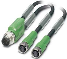
Sensor-/Aktor-Kabel, 3-polig, PUR halogenfrei, schwarzgrau RAL 7021, Stecker gerade M12, Kodierung: A, auf Buchse gerade M8, Kodierung: A und Stecker gerade M8, Kodierung: A, Kabellänge: 0,2 m
