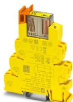
Sicheres Koppelrelais mit zwangsgeführten Kontakten, galvanisch getrennt, 2 Wechslerkontakte, 1-kanalig, Push-in-Anschluss, Breite: 14 mm
