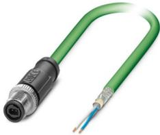
Netzwerkkabel, Single Pair Ethernet CAT B (1 GBit/s), 2-polig, PUR halogenfrei, grün, geschirmt (Advanced Shielding Technology), Stecker gerade M12-SPE / IP67, auf freies Leitungsende M12-SPE, Kabellänge: 10 m
