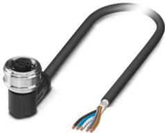
Sensor-/Aktor-Kabel, 5-polig, PUR halogenfrei, schwarzgrau RAL 7021, geschirmt (Advanced Shielding Technology), Buchse gewinkelt M12 Push-Pull, Kodierung: A, auf freies Leitungsende, Kabellänge: 5 m
