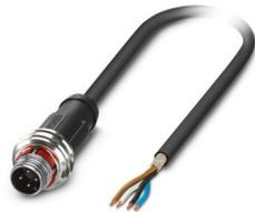
Sensor-/Aktor-Kabel, 4-polig, PUR halogenfrei, schwarzgrau RAL 7021, geschirmt (Advanced Shielding Technology), Stecker gerade M12 Push-Pull, Kodierung: A, auf freies Leitungsende, Kabellänge: 1,5 m
