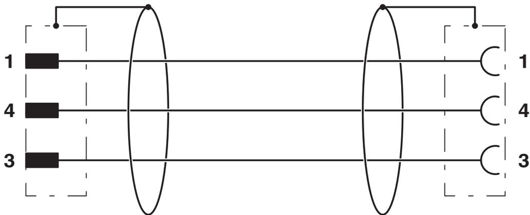
Kontaktbelegung des M12-Steckers und der M12-Buchse
