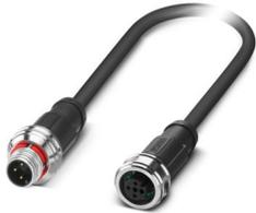
Sensor-/Aktor-Kabel, 3-polig, PUR halogenfrei, schwarzgrau RAL 7021, geschirmt (Advanced Shielding Technology), Stecker gerade M12 Push-Pull, Kodierung: A, auf Buchse gerade M12 Push-Pull, Kodierung: A, Kabellänge: 0,3 m
