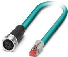
Netzwerkkabel, Ethernet CAT5 (100 MBit/s), 4-polig, PUR halogenfrei, wasserblau RAL 5021, geschirmt (Advanced Shielding Technology), Buchse gerade M12 Push-Pull, Kodierung: D / IP67, auf Stecker gerade RJ45 / IP20, Kabellänge: 2 m
