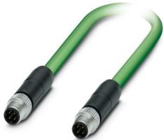
Netzwerkkabel, PROFINET CAT5 (100 MBit/s), EtherCAT® CAT5 (100 MBit/s), 4-polig, PVC/PVC, grün RAL 6018, geschirmt (Advanced Shielding Technology), Stecker gerade M8, Kodierung: D / IP67, auf Stecker gerade M8, Kodierung: D / IP67, Kabellänge: 30 m
