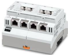
Unmanaged Switch 1000 REG Serie, 4 RJ45-Ports 10/100/1000 MBit/s, 4 RJ45-PoE-Ports, Schutzart: IP20, Umgebungstemperatur (Betrieb): 5 °C ... 50 °C, Versorgungsspannungsbereich: 48 V DC ... 55 V DC, REG Bauform nach DIN 43880
