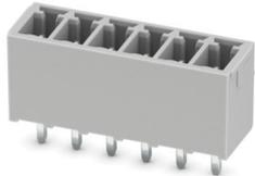
Leiterplatten-Grundleiste, Nennquerschnitt: 1,5 mm<sup>2</sup>, Farbe: grau, Nennstrom: 8 A, Kontaktoberfläche: Sn, Kontaktart: Stift, Anzahl der Reihen: 1, Polzahl: 6, Artikelfamilie: MCV 1,5/...-G, Rastermaß: 3,5 mm, Montage: Wellenlöten, Pin-Layout: Lineares Pinning, Pinlänge [P]: 3,4 mm, Anzahl der Lötpins pro Potenzial: 1, Stecksystem: COMBICON MC 1,5, Ausrichtung Steckgesicht: Standard, Verriegelung: ohne, Befestigungsart: ohne, Verpackungsart: verpackt im Karton
