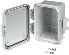
Outdoor-Gehäuse, Farbe: lichtgrau, Abmessung: 223 x 204 134 mm (8" x 6" x 4"), inkl. Eckenleger, Deckelstopfen, Schrauben, Deckel: lichtgrau, Schnappverschluss Kunststoff, Material: PC UV-stabilisiert
