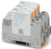
Überspannungsableiter, gem. Typ 2 / Class II, für 2-polige isolierte und geerdete PV-Gleichspannungssysteme 1500 V DC, für Tragschienenmontage, 3-poliges Basiselement mit Fernmeldekontakt, drei steckbare temperaturüberwachte Schutzelemente, Statusmeldung an jedem Stecker.
