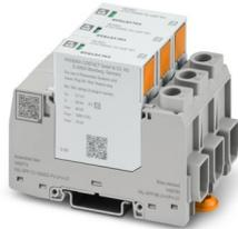
Überspannungsableiter, gem. Typ 2 / Class II, für 2-polige isolierte und geerdete PV-Gleichspannungssysteme 1500 V DC, für Tragschienenmontage, 3-poliges Basiselement, drei steckbare temperaturüberwachte Schutzelemente, Statusmeldung an jedem Stecker.
