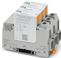
Überspannungsableiter, gem. Typ 2 / Class II, für 2-polige isolierte und geerdete PV-Gleichspannungssysteme 600 V DC, für Tragschienenmontage, 3-poliges Basiselement, drei steckbare temperaturüberwachte Schutzelemente, Statusmeldung an jedem Stecker.
