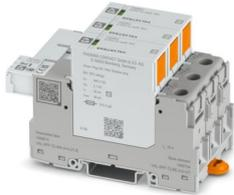
Steckbarer Überspannungsableiter, gem. Typ 2 / Class II, für 3-phasige Stromversorgungsnetze mit kombiniert verlegtem PE und N in einem Leiter (4-Leitersystem: L1, L2, L3, PEN), mit Fernmeldekontakt.
