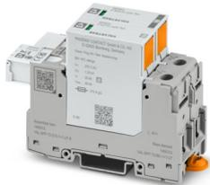
Steckbarer Überspannungsableiter, gem. Typ 2 / Class II, für 1-phasige Stromversorgungsnetze mit separatem N und PE (3-Leitersystem: L1, N, PE), mit Fernmeldekontakt.
