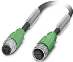
Sensor-/Aktor-Kabel, 5-polig, PUR halogenfrei, schwarzgrau RAL 7021, geschirmt, Stecker gerade M12, auf Buchse gerade M12, Kabellänge: 3 m
