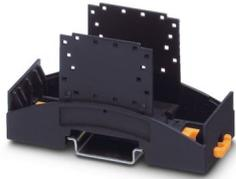
Tragschienengehäuse für den Einsatz in Installationsverteilern nach DIN 43880, Gehäuseunterteil mit Fußriegel, Breite: 35,6 mm, Höhe: 89,7 mm, Tiefe: 48,9 mm, Farbe: schwarz (ähnlich RAL 9005), Querverbindung: Tragschienen-Busverbinder (optional), Polzahl Querverbinder: 16, mit montiertem Fußriegel
