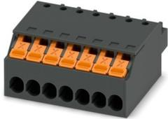
Leiterplattenstecker, Nennquerschnitt: 1,5 mm<sup>2</sup>, Farbe: schwarz, Nennstrom: 8 A, Bemessungsspannung (III/2): 160 V, Kontaktoberfläche: Sn, Kontaktart: Buchse, Anzahl der Reihen: 1, Polzahl: 7, Artikelfamilie: XPC 1,5/..-ST, Rastermaß: 3,5 mm, Anschlussart: Push-X-Anschluss, Anschlussrichtung Leiter/Platine: 0 °, Rasthaken: - ohne Rasthaken, Stecksystem: COMBICON MC 1,5, Verriegelung: ohne, Befestigungsart: ohne, Verpackungsart: verpackt im Karton
