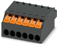
Leiterplattenstecker, Nennquerschnitt: 1,5 mm<sup>2</sup>, Farbe: schwarz, Nennstrom: 8 A, Bemessungsspannung (III/2): 160 V, Kontaktoberfläche: Sn, Kontaktart: Buchse, Anzahl der Reihen: 1, Polzahl: 6, Artikelfamilie: XPC 1,5/..-ST, Rastermaß: 3,5 mm, Anschlussart: Push-X-Anschluss, Anschlussrichtung Leiter/Platine: 0 °, Rasthaken: - ohne Rasthaken, Stecksystem: COMBICON MC 1,5, Verriegelung: ohne, Befestigungsart: ohne, Verpackungsart: verpackt im Karton
