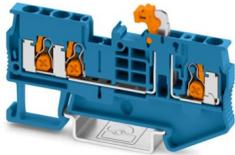
Messertrennklemme, Nennspannung: 500 V, Nennstrom: 20 A, Anschlussart: Push-X-Anschluss, Bemessungsquerschnitt: 2,5 mm<sup>2</sup>, Querschnitt: 0,5 mm<sup>2</sup> - 4 mm<sup>2</sup>, Montage: NS 35/7,5, NS 35/15, Farbe: blau
