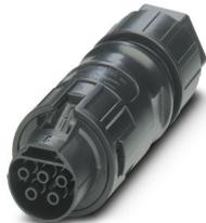
Kupplungssteckverbinder, Artikelfamilie: PRC 35, Bauform: Entriegelung mit Werkzeug oder von Hand (siehe Zubehör), Farbe: schwarz, Polzahl: 5, Aderquerschnitt min.: 1,5 mm<sup>2</sup>, Aderquerschnitt max.: 6 mm<sup>2</sup>, Bemessungsspannung: 690 V AC, Bemessungsstrom: 35 A, Anschlussart: Schraubanschluss, Kabeldurchmesser min.: 8 mm, Kabeldurchmesser max.: 21 mm, Variante zur Entriegelung von Hand
