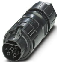
Kupplungssteckverbinder, Artikelfamilie: PRC 35, Bauform: Entriegelung mit Werkzeug oder von Hand (siehe Zubehör), Farbe: schwarz, Polzahl: 3, Aderquerschnitt min.: 1,5 mm<sup>2</sup>, Aderquerschnitt max.: 6 mm<sup>2</sup>, Bemessungsspannung: 690 V AC, Bemessungsstrom: 35 A, Anschlussart: Schraubanschluss, Kabeldurchmesser min.: 8 mm, Kabeldurchmesser max.: 21 mm, Variante zur Entriegelung von Hand
