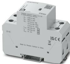
Kompakter, nicht-steckbarer und leckstromfreier Blitzstrom- / Überspannungsableiter auf Basis verschleißfreier Carbon-Funkenstreckentechnologie für 1-phasige Stromversorgungsnetze mit separatem N und PE (3-Leitersystem: L1, N, PE), geeignet für den Einsatz im Vorzählerbereich, Ableitvermögen bis 100 kA für die Blitzschutzklassen I und II.
