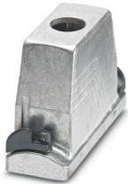
HEAVYCON ADVANCE-Tüllengehäuse B24, mit Bajonettverriegelung (Innensechskant) aus Edelstahl, seewasserbeständiges Aluminium, Höhe 100 mm, mit Gewinde 1x M32, geradem Kabelabgang, ohne Oberfläche; leitfähige Dichtung (EMV-Eigenschaften)
