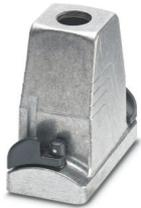
HEAVYCON ADVANCE-Tüllengehäuse B10, mit Bajonettverriegelung (Innensechskant) aus Edelstahl, seewasserbeständiges Aluminium, Höhe 100 mm, mit Gewinde 1x M32, geradem Kabelabgang, ohne Oberfläche; leitfähige Dichtung (EMV-Eigenschaften)
