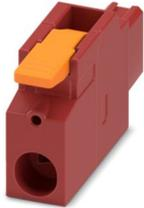
Leiterplattenstecker, Nennquerschnitt: 16 mm<sup>2</sup>, Farbe: rot, Nennstrom: 76 A, Bemessungsspannung (III/2): 1000 V, Kontaktoberfläche: Sn, Kontaktart: Buchse, Anzahl der Reihen: 1, Polzahl: 1, Artikelfamilie: LPC 16 HC/...-ST, Rastermaß: 10,16 mm, Anschlussart: Hebel-Push-in-Anschluss, Anschlussrichtung Leiter/Platine: 0 °, Rasthaken: - ohne Rasthaken, Stecksystem: POWER COMBICON 16 advanced, Verriegelung: ohne, Befestigungsart: ohne, Verpackungsart: verpackt im Karton
