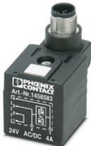
Ventilstecker, 4-polig, Stecker gerade M12, Kodierung: A, auf Ventilstecker A (DESINA), mit 1 LED, Beschaltung: Z-Diode
