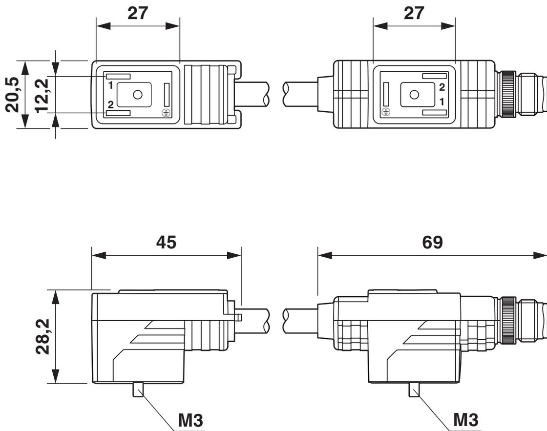
Doppelventilstecker, 2x Bauform BI
