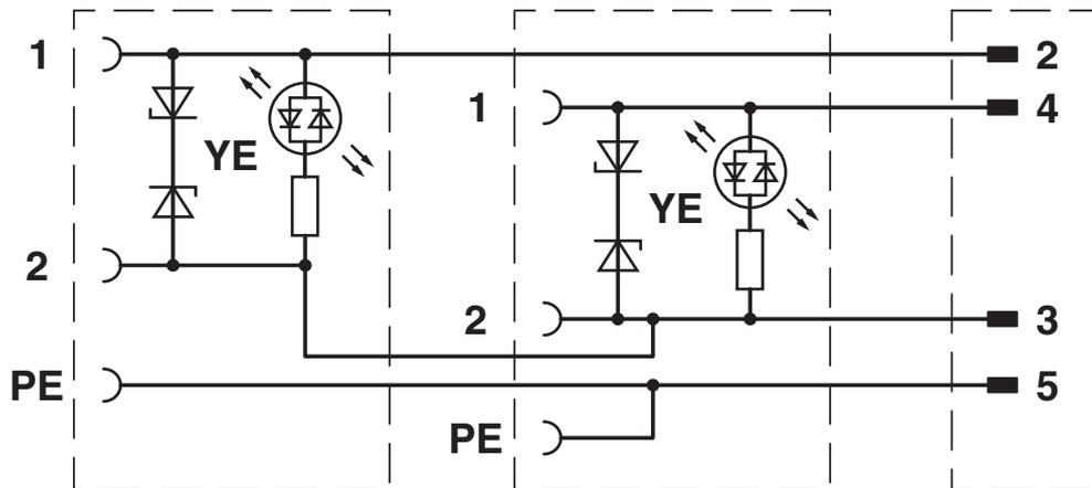
Kontaktbelegung des Doppelventilsteckers
