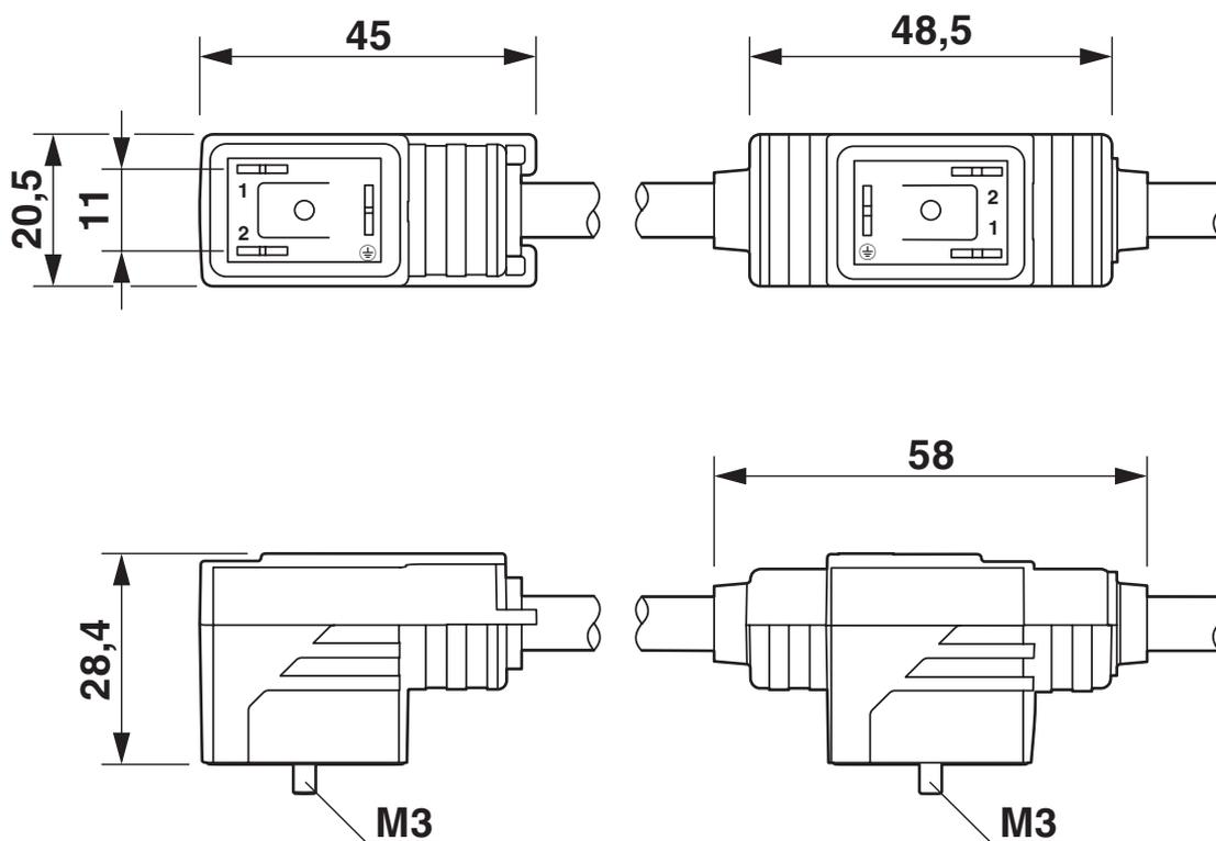
Doppelventilstecker, 2x Bauform BI
