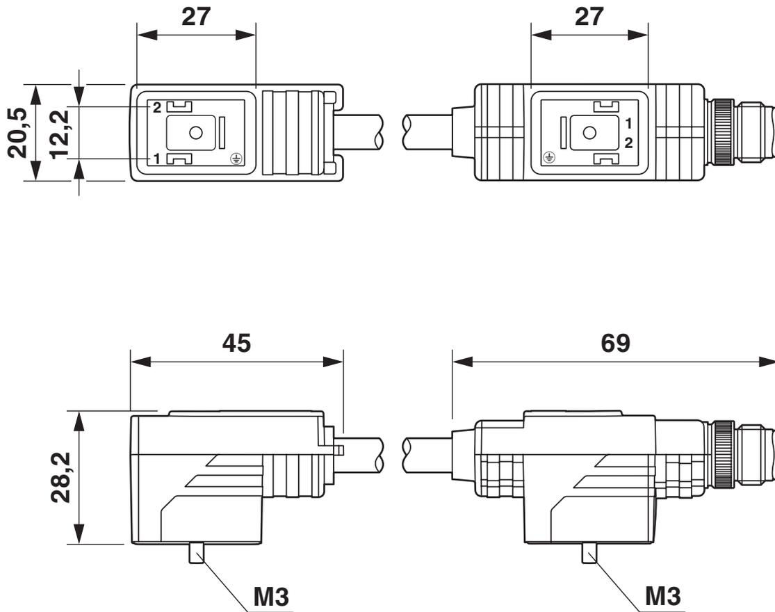
Doppelventilstecker, 2x Bauform B
